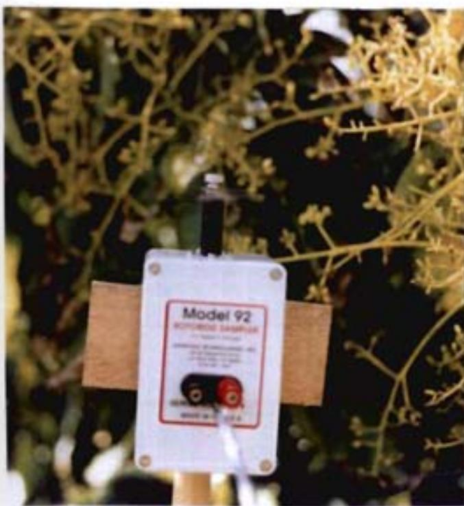
תמונה 6: דוגם אבקה רוטורי (Rotorod Sampler) בפעולה.
