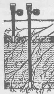
Esquema de la instalación de tensiómetros a diferentes profundidades.
